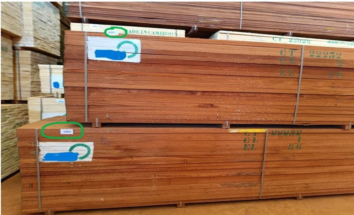
**Figure 7** : Marquage des colis des bois transformés aux codes à barres
