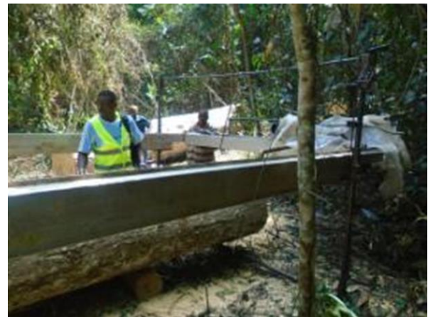
Photo 4 (b) : Lucas Mill au chantier
