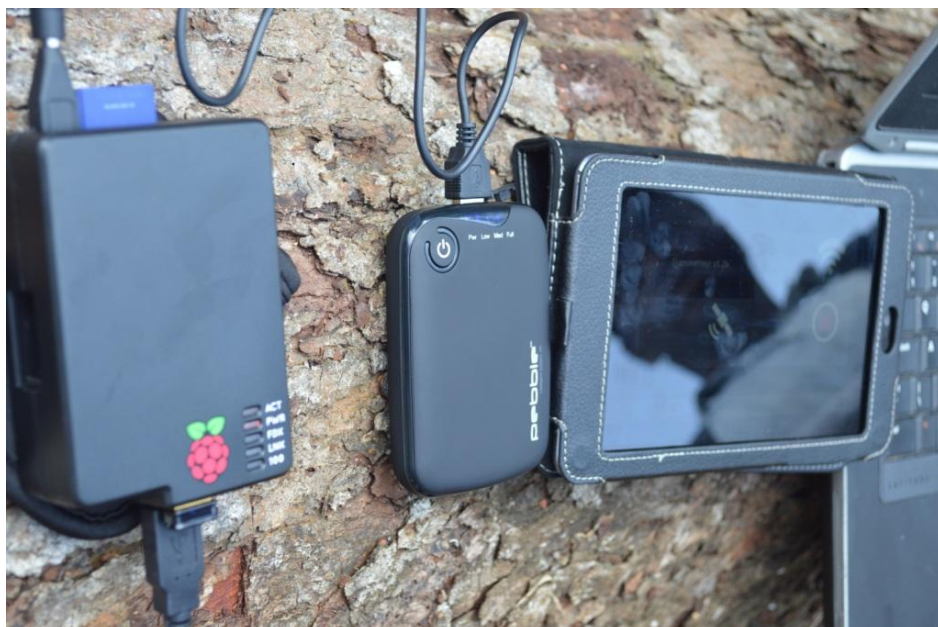
Les outils du SSTR; de la gauche vers la droite, un transmetteur, un chargeur intelligent, une tablette GPS et un ordinateur. © FODER, 2014
